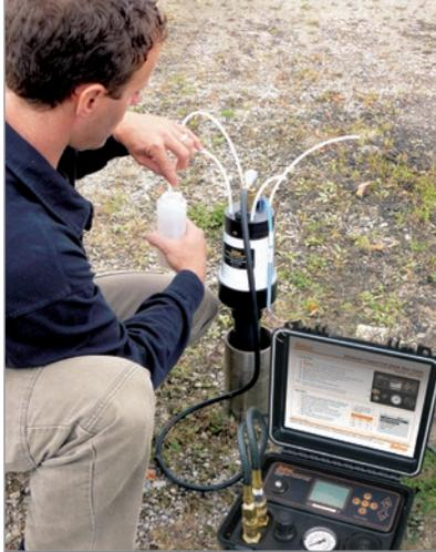
Prélèvement d'un échantillon dans un DVP dédié et mesure de la pression avec le lecteur de fil vibrant Geokon modèle 404.
