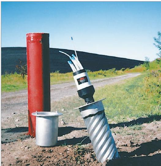
Une étude des propriétés hydrauliques sous un grand site de déchets. Les systèmes multi-niveaux de Waterloo ont été choisis pour permettre l'échantillonnage de la qualité de l'eau et pour aider à déterminer les zones de plus grande perméabilité dans l'aquifère.
