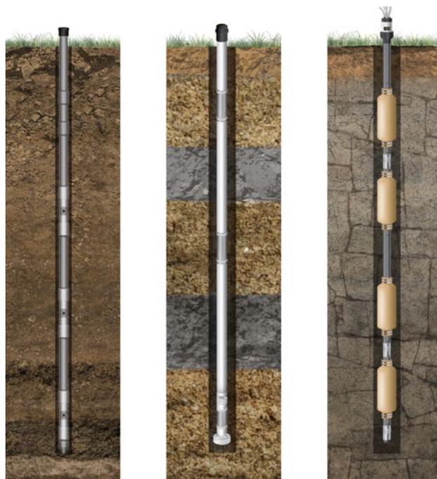
Piézomètre à points d'entraînement multiniveaux 615ML
