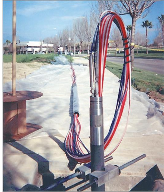
Recherche de contaminants sur une base de l'armée de l'air américaine. Les systèmes Waterloo ont été installés jusqu'à 213 m (700 ft) dans les morts-terrains en utilisant des puits blindés et tubés. Jusqu'à 6 zones par trou avec des pompes et des transducteurs dédiés.
