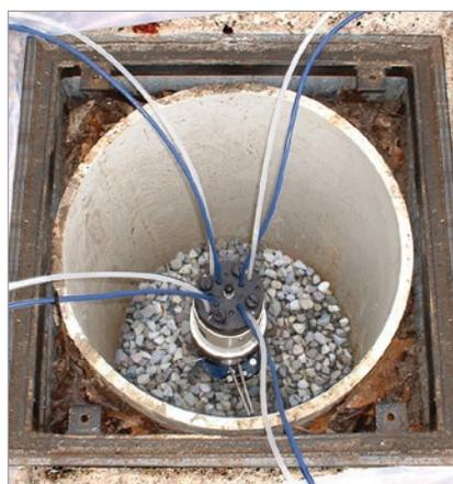
Utilisation des journaux de carottage pour identifier l'emplacement des ports et des packers (à gauche) Collecteur multi-purge avec transducteurs et pompes dédiées pour la surveillance de quatre zones (à droite).
