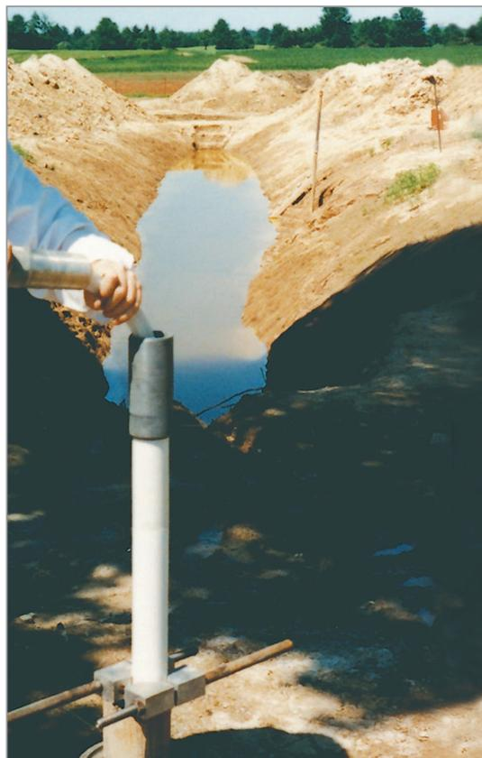
Évaluation des fuites d'oléoducs souterrains. Trois installations de 45 m (150 ft). Des tests de perméabilité à tête montante en deux points ont été effectués dans chaque intervalle du système multi-niveaux. (Voir le diagramme montrant la distribution des contaminants à gauche)
