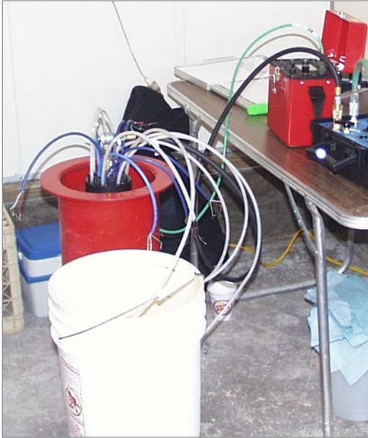
Quatre systèmes Waterloo ont été installés pour surveiller un rejet de composés chlorés. Les systèmes ont été installés à des profondeurs allant de 131 m à 229 m (430 ft - 750 ft), la plupart surveillant 7 zones. Les ports ont été construits avec des pompes à double vanne et des transducteurs à fil vibrant.
