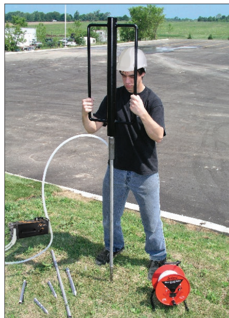
Installation de piézomètres avec un extracteur à inertie manuel
