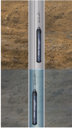
Installation de la corde de suspension
