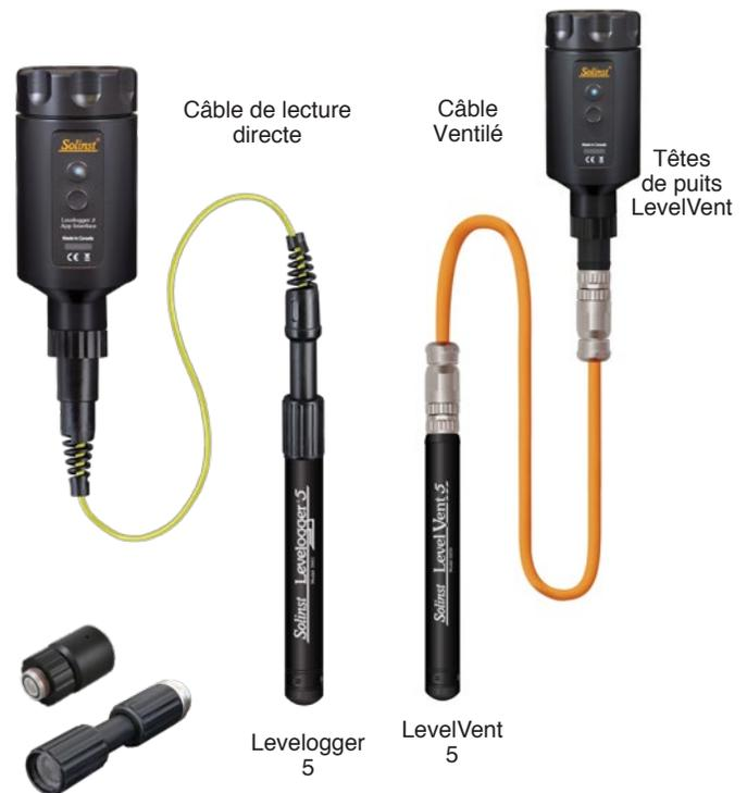
Les adaptateurs filetés et coulissants L5 vous permettent de connecter directement votre Levellogger à l'interface Levellogger 5 App.
