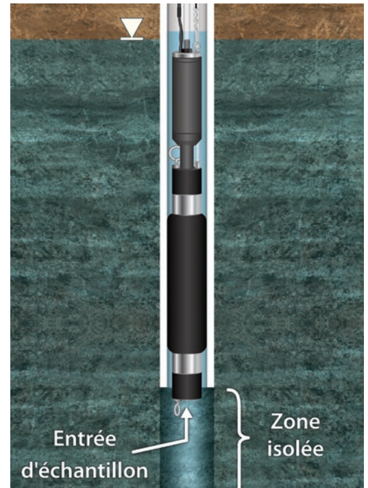
Un packer modèle 800M peut être utilisé pour isoler la zone d'échantillonnage et réduire les volumes de purge.
