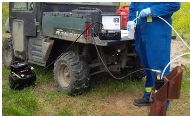
Échantillonnage avec une pompe à vessie dédiée et un ensemble compresseur et module de contrôle portable, robuste et facile à utiliser
