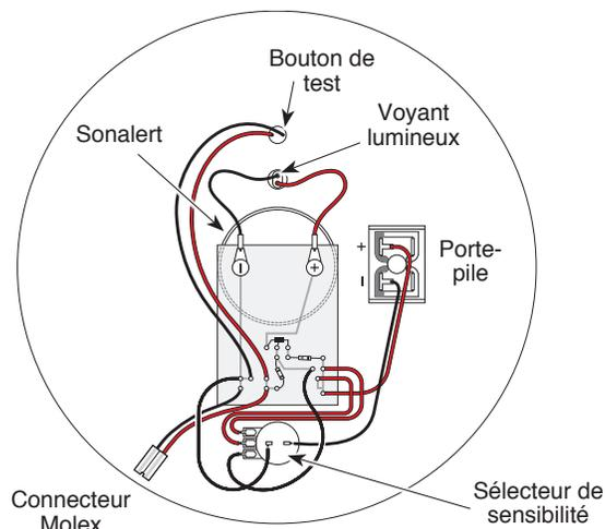
Arrière de la plaque frontale d'une sonde Mk1 102 montrant les connexions de câblage et l'emplacement des composants
