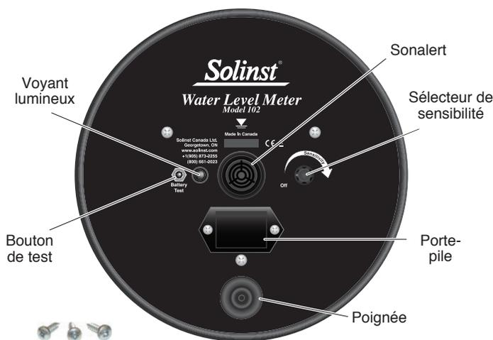
Ensemble de plaque frontale de remplacement pour sonde 102 montrant l'emplacement des composants (fourni avec l'assemblage de la poignée et 3 vis à tête cruciforme)
