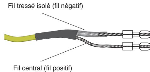
21. Remplacez la pile. Placez la sonde dans un verre d'eau du robinet, puis allumez la sonde de niveau d'eau en plaçant son interrupteur sur la position « ON ». Si les connexions sont correctes, l'avertisseur sonore retentit et le voyant lumineux sur l'appareil s'allume. Si l'avertisseur sonore et le voyant lumineux ne s'activent pas, vérifiez les connexions, ainsi que la polarité de la pile.
