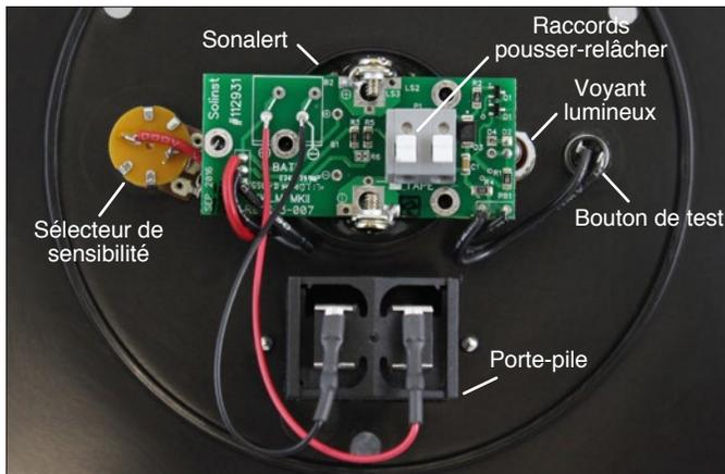
Arrière de la plaque frontale d'une sonde Mk2 102 avec un voyant lumineux nouveau modèle
