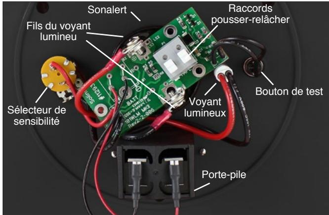
Arrière de la plaque frontale d'une sonde Mk2 102 avec un voyant lumineux ancien modèle
