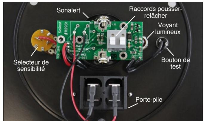
Arrière de la plaque frontale d'une sonde Mk2 102 avec un voyant lumineux nouveau modèle
