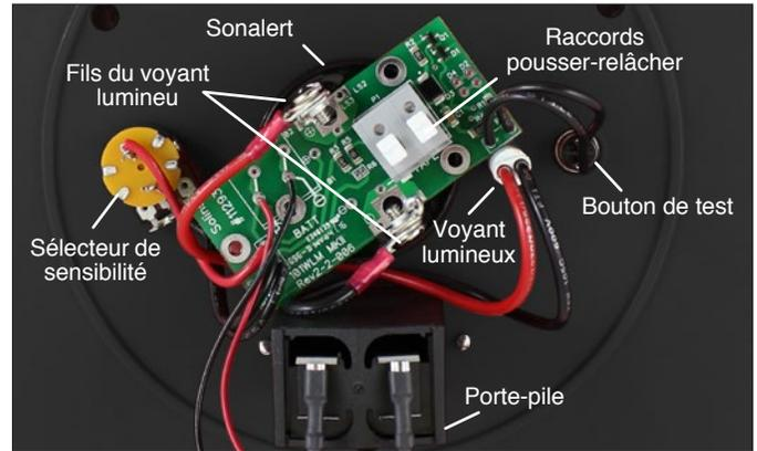
Arrière de la plaque frontale d'une sonde Mk2 102 avec un voyant lumineux ancien modèle
