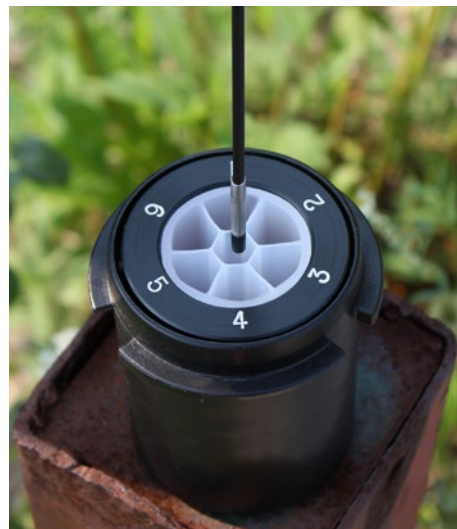
Mesure des niveaux d'eau dans les canaux étroits d'un système Solinst CMT®.
