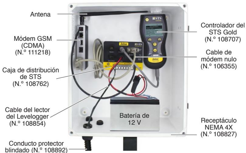
**Figura 6-3 Configuración estándar de estación remota (batería de 12 V no suministrada por Solinst)**
