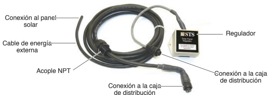
**Figura 6-4 Paquete con conector de energía solar (N.º 108988)**
