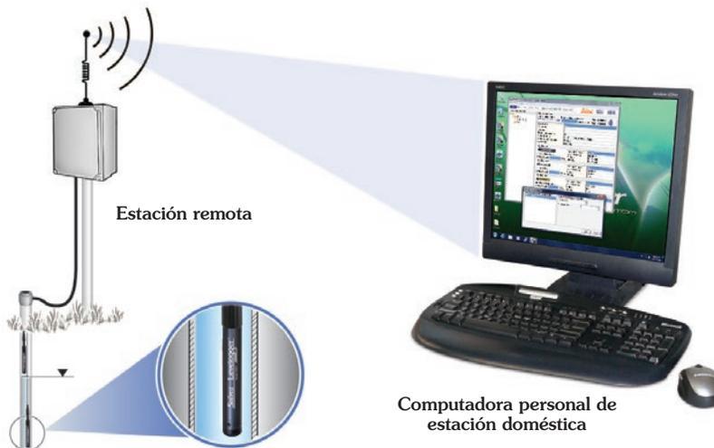
Los sistemas STS Gold se pueden configurar usando comunicaciones digitales celulares basadas en GSM o CDMA. Los datos se "remiten" desde la estación remota hasta la estación doméstica usando una IP (Protocolo de Internet) y de esa manera, los inconvenientes de marcado o control de tiempo no son un problema. El controlador del STS almacena datos en su memoria hasta que la computadora de la estación doméstica los haya cargado correctamente.
