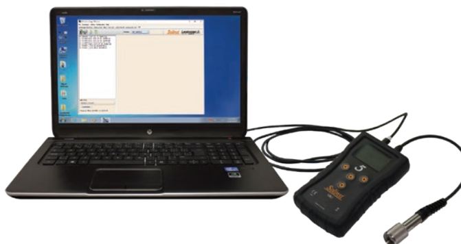
Figura 7-2 Conexión de SRU a PC
