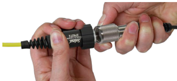
Figura 3-1 Conexión del Levellogger
