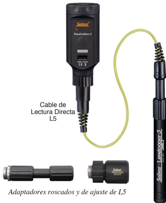
b) Conecte el DataGrabber al Cabezal del LevelVent 5
