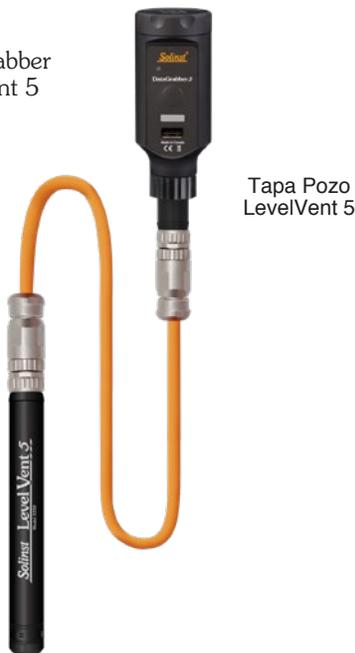
c) Conecte el DataGrabber a su Tapa Pozo AquaVent 5 utilizando un Cable Conector DataGrabber.
