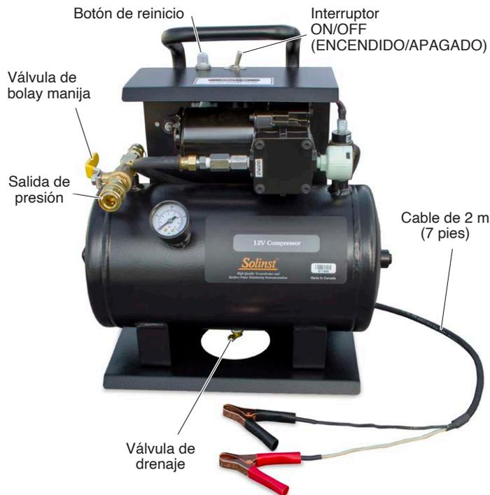
6. Una vez que comience el bombeo, la presión de aire en el tanque caerá a 100 psi. Luego el compresor volverá a cargarse a 150 psi o a la clasificación de bombeo seleccionada.
