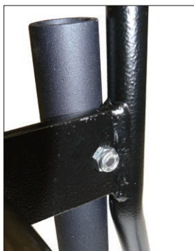
Conexión del soporte de la sonda antigua al bastidor
