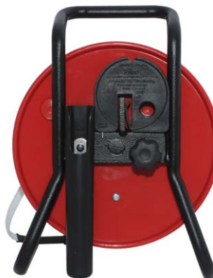
Nuevo soporte de sonda MKII conectado al bastidor
