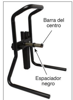
12. Reemplace las tres arandelas sobre la barra del centro (la arandela de nylon entre las dos arandelas de acero inoxidable) y vuelva a instalar el anillo de retención sobre la barra del centro.
