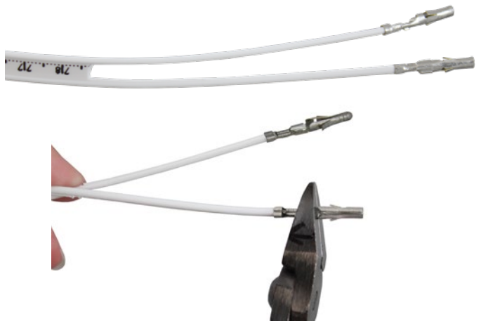
Corte las clavijas de cada cable de la cinta por la mitad (como se muestra)
