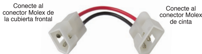
Cable de puente (cinta nueva: clavija 3 a clavija 2) (n.º 110508)
