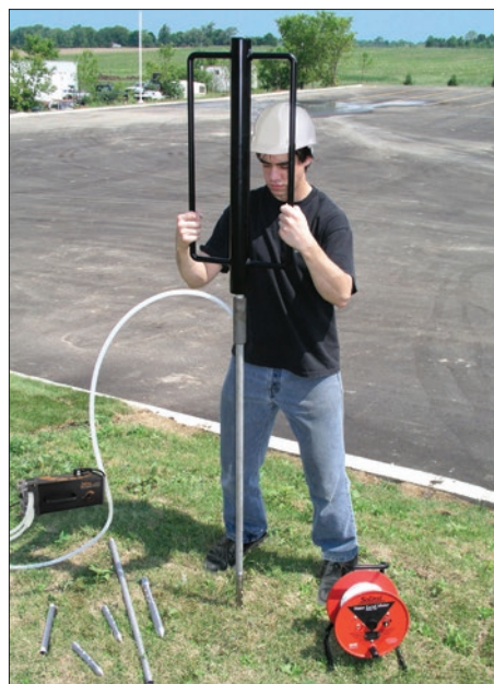
Instalación de piezómetros con un martillo deslizante manual
