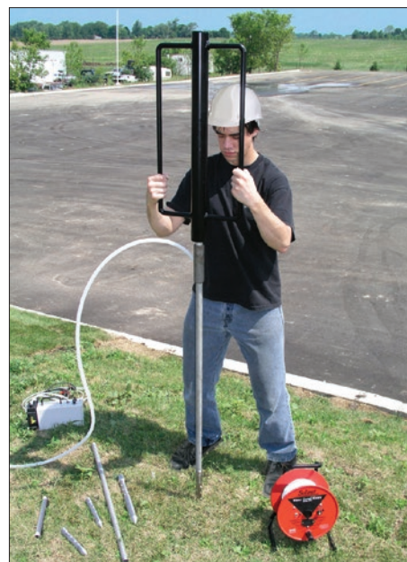
Instalación de piezómetros con un martillo deslizante manual
