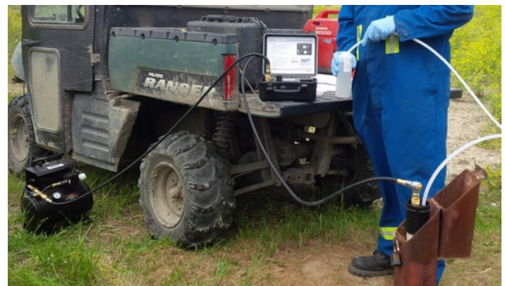
Muestreo con una bomba de vejiga dedicada mediante el uso de un controlador y compresor portátil, resistente y fácil de usar
