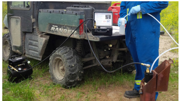
Muestreo con una bomba de vejiga dedicada mediante el uso de un controlador y compresor portátil, resistente y fácil de usar
