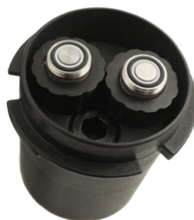
Tapa pozo con dos Levellogger con cables de lectura directa instalados (un orificio de acceso adicional disponible para monitoreo)
