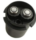
Tapa pozo con dos Levelogger con cables de lectura directa instalados (un orificio de acceso adicional disponible para monitoreo)
