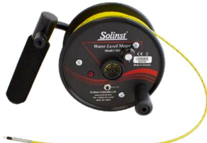
El cable coaxial marcado con laser esta montado sobre un carrete pequeño (mini) liviano y cabe fácilmente en un moral. El cable esta marcado exactamente en incrementos de cada milímetro o 1/100 de pie.
