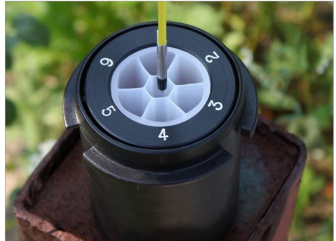
Mediciones hechas a través de los canales angostos del sistema Multicanal CMT® de Solinst.
